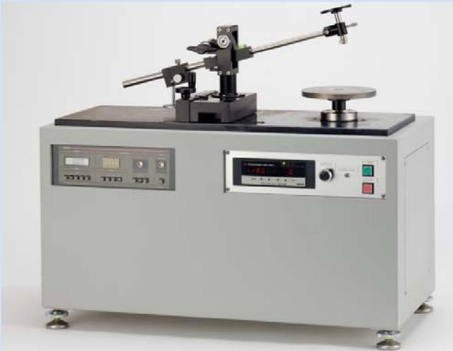
力矩转换器直接和放置试样的转台相连。在加载表面上，接触盘和点接触上的杆硬度计因为盘和杆的硬度计压头可以自动平衡，因此可以进行从低载荷起的精确的摩擦磨损实验。
