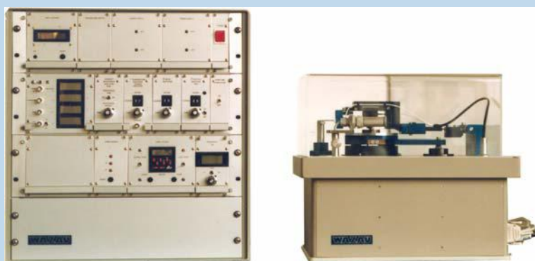
SVT 40 高频往复摩擦试验机 (HFRR) 适合于平移往复运动 符合 ASTM D6079
